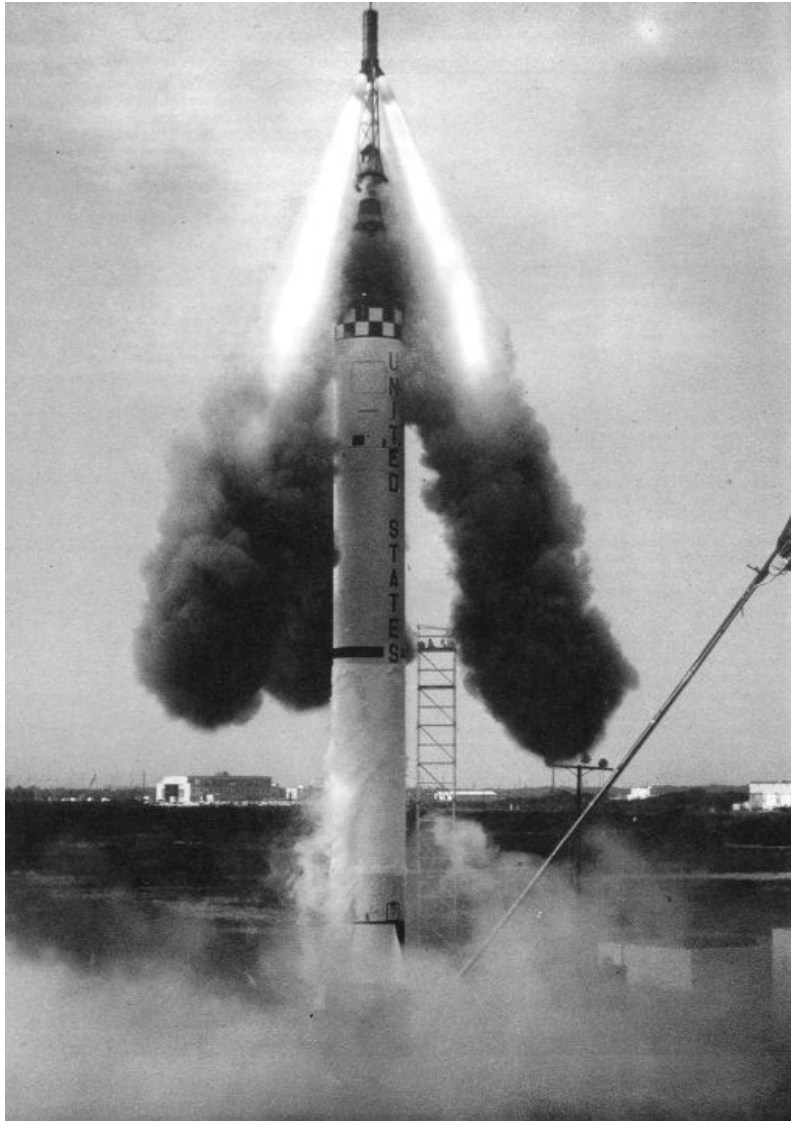
78. El lanzamiento de la misión MR-1 fue un fracaso, aunque rápidamente solucionado (en la fotografía, el dispositivo de emergencia conocido como «torre escape» acaba de activarse).
