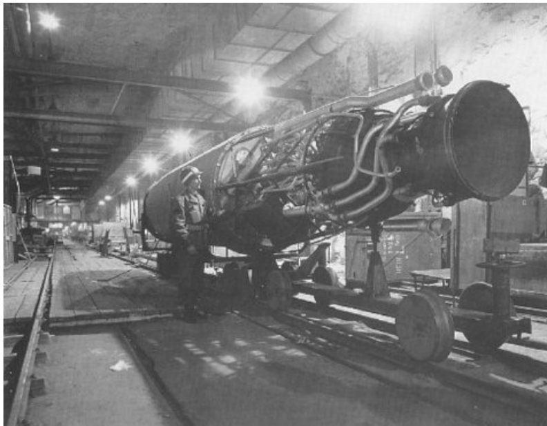
37. Un soldado norteamericano examina una V-2 a medio montar en los túneles de la factoría de Mittelwerk.
