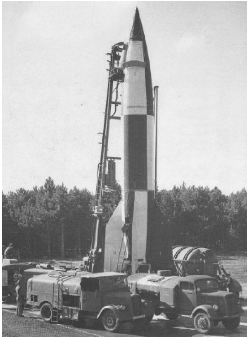
29. Las V-2 precisaban de un complejo soporte logístico para su lanzamiento, con decenas de camiones y centenares de soldados para ponerlas a punto. Ello limitaba severamente su operatividad bélica.
